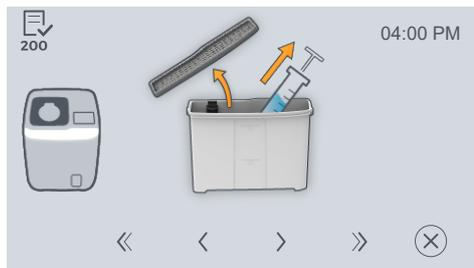
9. Entnehmen Sie etwas Wasser mit einer Spritze (mindestens 10 ml) aus dem Wassertank.
