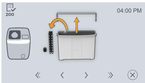
5. Demontieren Sie den Wassertank, indem Sie den Griff, den Deckel und den Schwimmer inkl. Schwimmerführung entfernen.
