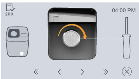
12. Schrauben Sie den Deckel des Filtergehäuses mit dem Schraubendreher mit dem Uhrzeigersinn wieder ein.
