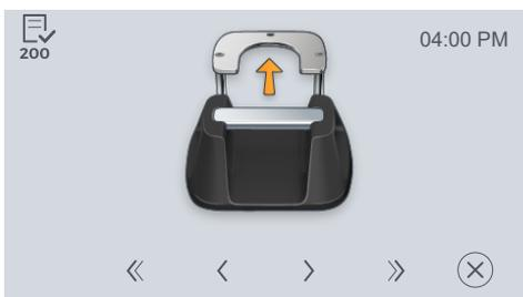
5. Setzen Sie den Deckel vorne auf die Halterung des DAC Universal auf und führen Sie den Deckel geradlinig in die Halterung ein.
