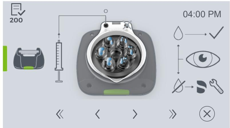
11. Injizieren Sie das Wasser mit der Spritze durch das linke Loch in den Kanal des Deckel Green (wie auf dem Bild dargestellt).
