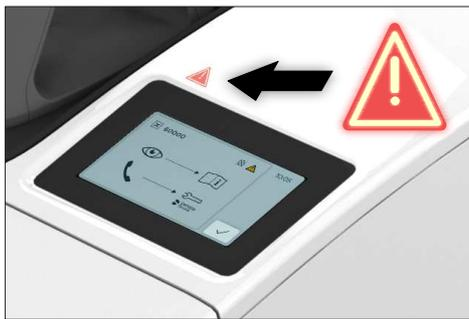
Es erscheint das Symbol, dass der Prozess abgebrochen wurde, ein Alarmton ertönt und die LED blinkt.
