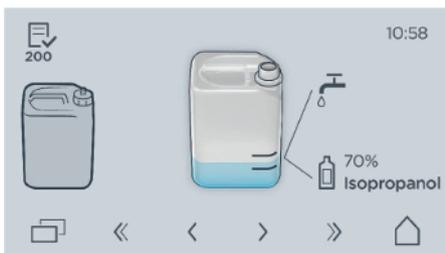
8. Füllen Sie den gereinigten Abwasserbehälter bis zur unteren Markierung auf dem Etikett mit Wasser.
