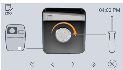
14. Schrauben Sie den Deckel des Filtergehäuses mit dem Schraubendreher mit dem Uhrzeigersinn wieder ein.
