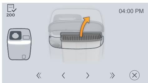
6. Entnehmen Sie den Wassertank, indem Sie vorsichtig den Wassertank am Griff aus dem DAC Universal nach oben ziehen.
